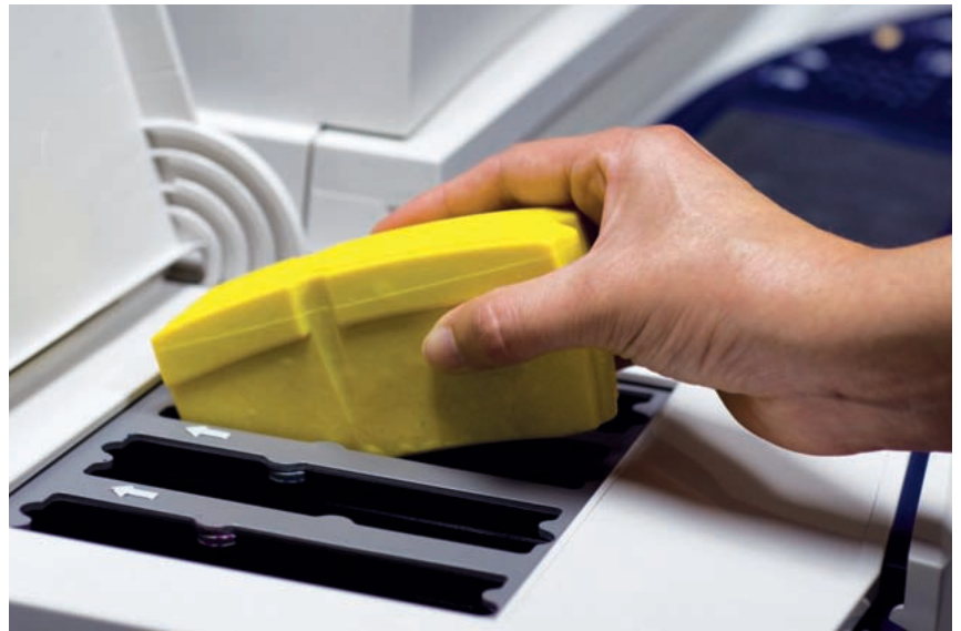
SCHNELL NACHGELADEN: Anstelle von Tinte oder Toner setzt Xerox bei seinem ColorQube sogenannte Festtinte in Form von Wachsklötzen ein.
