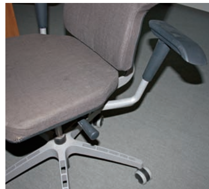
Die Arretierung der Armlehne brach beim „schwedischen Stuhl“ ab. Der Anwender findet so keinen Halt und damit ist der Stuhl nicht sicher und letztendlich nicht mehr nutzbar.
