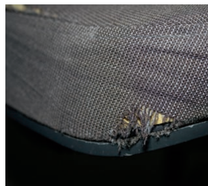
STARK BESCHÄDIGT: Nach dem Dauereinsatz von drei Jahren zeigte der Stoff des „Klappe“ große Risse und Ausfransungen.
