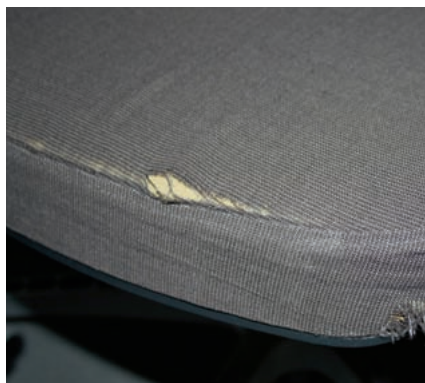
STARK BESCHÄDIGT: Nach dem Dauereinsatz von drei Jahren zeigte der Stoff des „Klappe“ große Risse und Ausfransungen.
