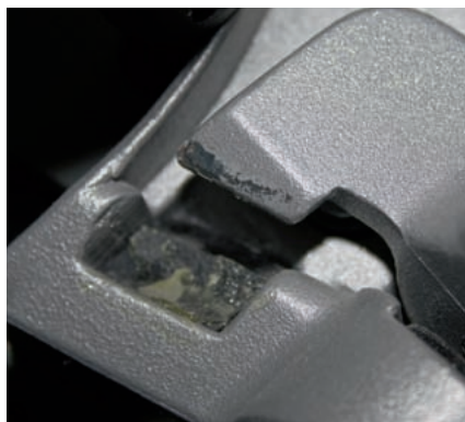
Die Arretierung der Armlehne brach beim „schwedischen Stuhl“ ab. Der Anwender findet so keinen Halt und damit ist der Stuhl nicht sicher und letztendlich nicht mehr nutzbar.
