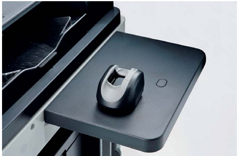
SICHERHEIT: Mit dem Venenscanner wird die Zugangskontrolle zum System gesichert.
