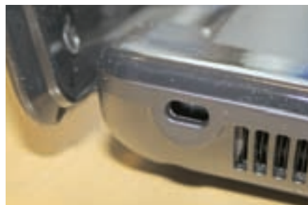
SICHER: An der Öse an der Seite eines Notebooks kann ein Kensington-Schloss zur Diebstahlsicherung angebracht werden.
