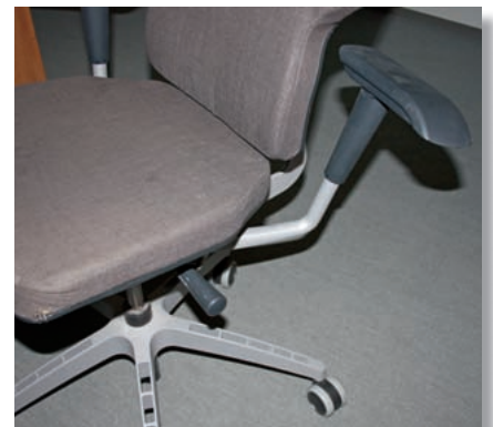
Die Arretierung der Armlehne brach beim „schwedischen Stuhl“ ab. Der Anwender findet so keinen Halt und damit ist der Stuhl nicht sicher und letztendlich nicht mehr nutzbar.
