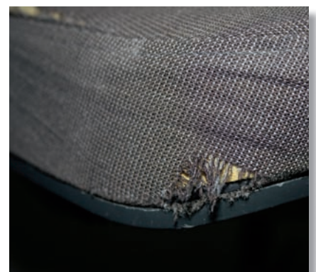
STARK BESCHÄDIGT: Nach dem Dauereinsatz von drei Jahren zeigte der Stoff des „Klappe“ große Risse und Ausfransungen.
